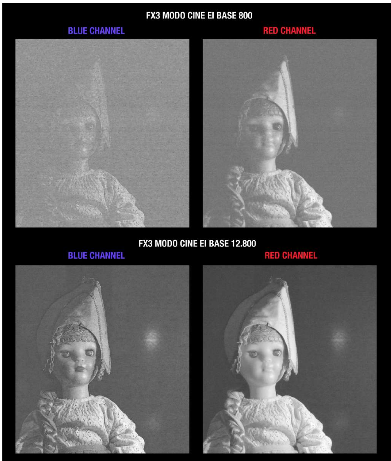
Figura 22. Canal azul y rojo a las dos EI Base en modo CINE EI. Hemos subido el brillo de los canales para ilustrar mejor las diferencias entre ambos.
